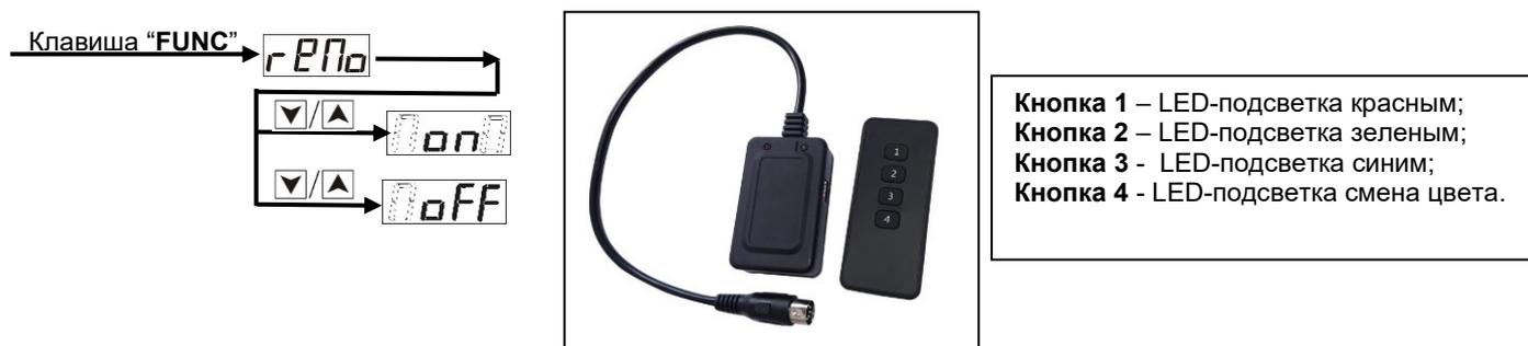
Подключите приемник пульта дистанционного управления к разъему, расположенному на задней панели генератора. После завершения прогрева нажмите кнопку "1", "2", "3", или "4" на пульте дистанционного управления, выброс дыма будет происходить автоматически с 100% мощностью.
