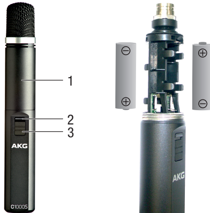
Figure 2: Mise en place des piles
